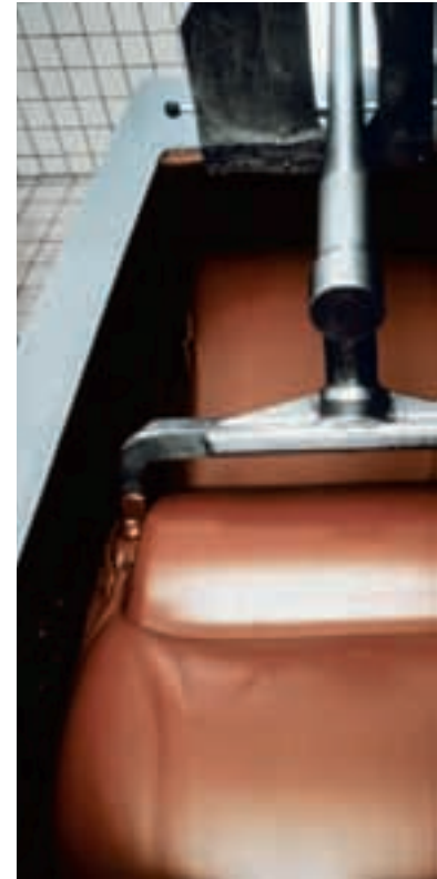
Rodolphe Lindts Fabrikationsgeheimnis war die von ihm entwickelte «Conche», eine Walzenreibmaschine, in der er die Schokolademasse 72 Stunden lang bewegte, wobei die Schokolademasse hocharomatisch, homogen und zartschmelzend wurde.
