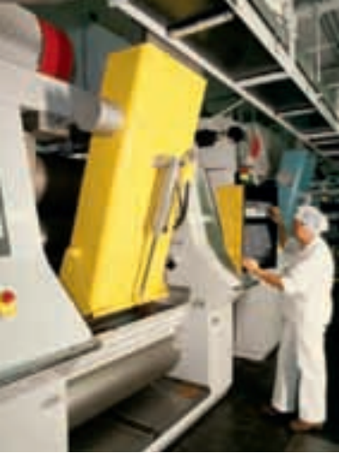
Walzwerk mit fünf Stahlrollen, die mit unterschiedlichen Drehzahlen rotieren, dadurch die Masse von unten nach oben befördern und ständig zerkleinern.
